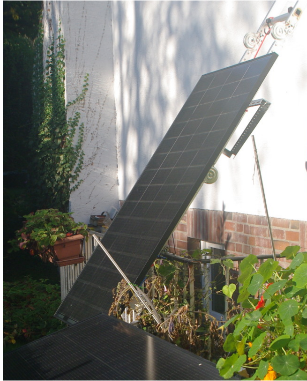
Abbildung 3: Als letzte Option wurde ein Modul hochkant auf einer Leiter befestigt, die an die Südwand gelehnt wurde.
